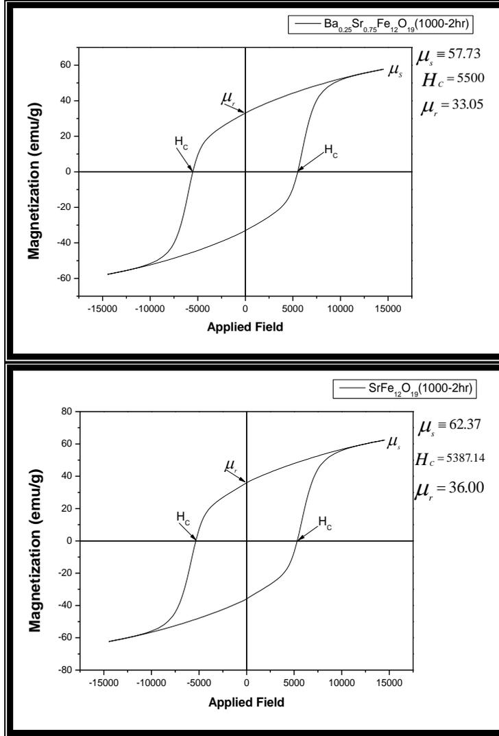
شكل يوضح حلقة الهستيرة للفرانيت  $Ba_{0.5}Sr_{0.5}Fe_{12}O_{19}$  ،
