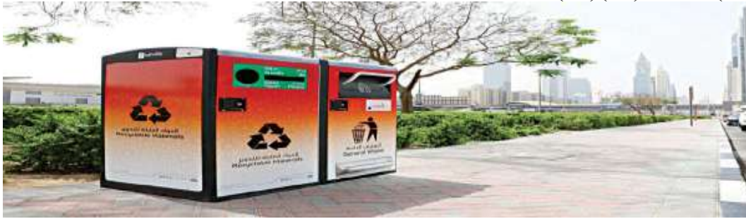
صورة (13): حاوية تعمل بالطاقة الشمسية (17)
