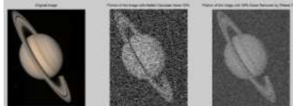
الشكل (12) يمثل الصورة الأصلية في اليسار، الصورة باضافة نسبة ضوضاء 50% في المنتصف، الصورة بازالة الضوضاء في اليمين باستعمال طريقة المرشح وينر Weiner Filter
