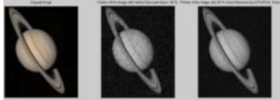
الشكل (15) يمثل الصورة الأصلية في اليسار، الصورة بإضافة نسبة ضوضاء 50% في المنتصف، الصورة بإزالة الضوضاء في اليمين باستعمال طريقة المرشح الإحصائي-LPG) PCA) Filter
