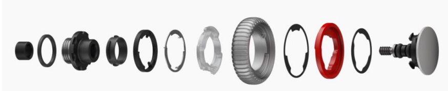
شكل (7) المكونات الدقيقة للجزء الدوار Digital Crown
