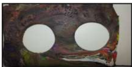
الشكل (4) القالب المستخدم قبل عملية صب النماذج
