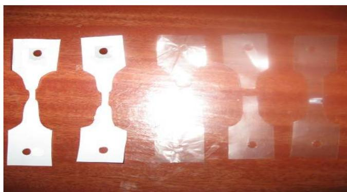
شكل (٧) عينات الاختبار قبل وبعد فحص الزحف
